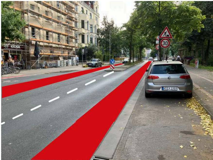
*Abb: Gefahrenstelle Mittelinsel bei Führung auf Schutzstreifen und Erhalt der Bauminsel; aus der anderen Fahrtrichtung entsprechend*
