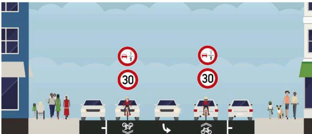
Abb: Unveränderte Aufteilung, Radverkehr auf der Fahrbahn, Tempoabsenkung, Überholverbot von einspurigen Fahrzeugen (streetmix.net)
