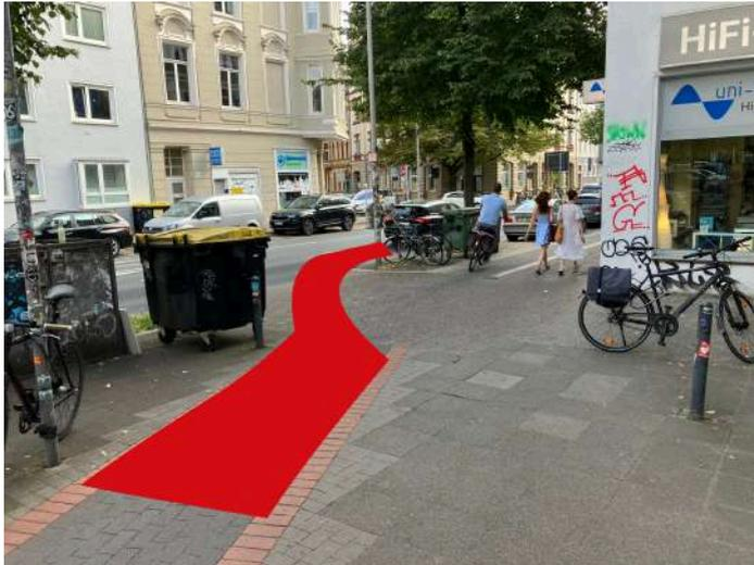
*Abb: Prinzipskizze Auffädelstelle auf die Fahrbahn hinter einer Schutzinsel (hier nicht visualisiert, wäre hinter dem Müllcontainer) vor der Verengung des Seitenraums.*
