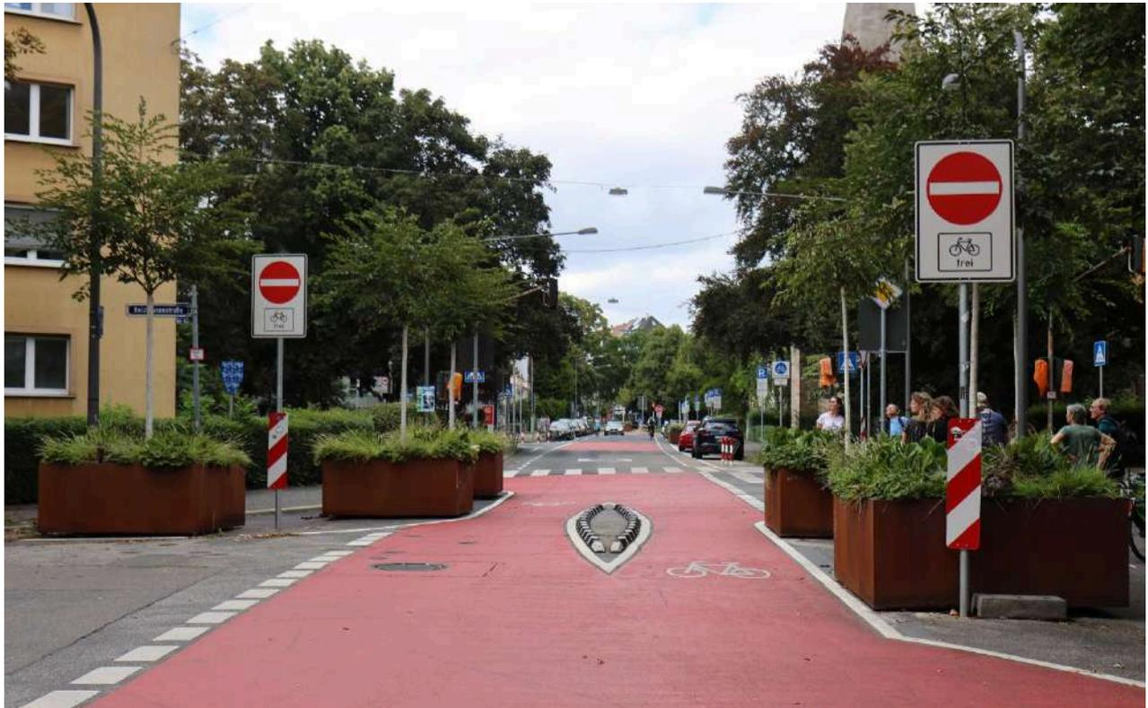
*Abb: Modalfilter mit Schleuse für Busse und Rettungsfahrzeuge (Aufnahme: ADFC)*
