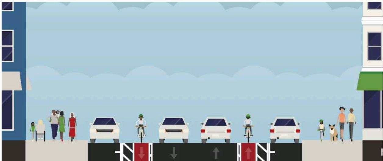
*Abb: Neu-Aufteilung durch Markierung von Schutzstreifen mit Sicherheitstrennstreifen (streetmix.net)*
